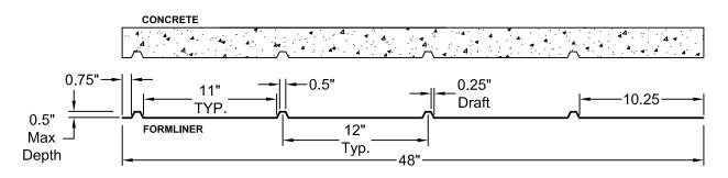
**SECTION A-A FORMLINER DETAIL**
